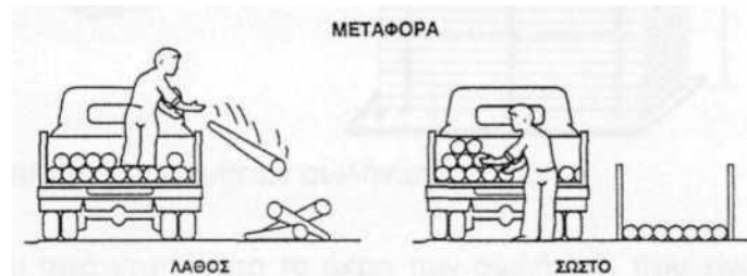
Σχήμα 5: Ανορθόδοξος και σωστός τρόπος φορτοεκφόρτωσης σωλήνων.
